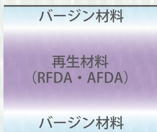
直接食品に触れる面はA-PET 素材、中間層はリサイクルされたPET 素材の2種3層で構成されています。
